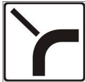
Esquema que indica la intersección que se aproxima y la vía que posee preferencia en esa intersección
