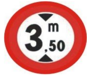
Circulación prohibida a los vehículos que excedan la altura indicada
