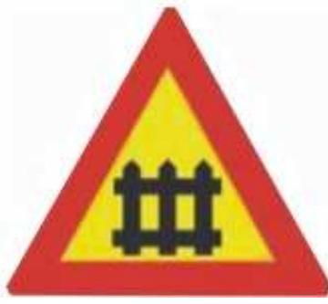
Paso a nivel con barreras
